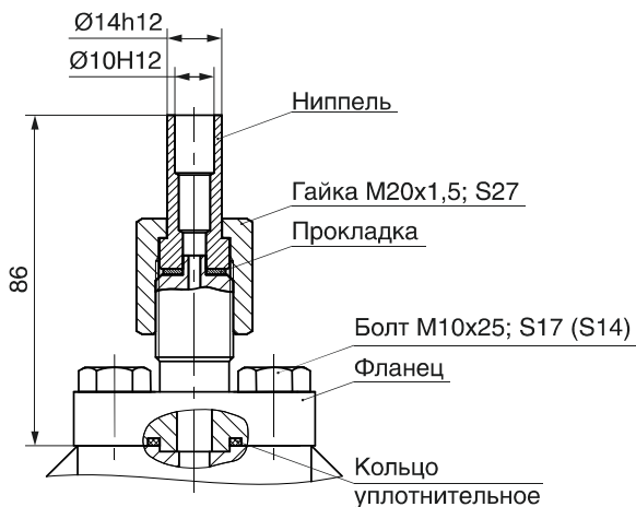
Рисунок Д.3 — Датчик с установленным ниппелем под накладную гайку M20x1,5 (в количестве 1 или 2 в зависимости от модели). Остальное см. рисунок Д.1.
